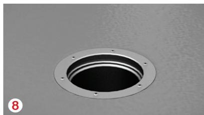
Mise en place de vis de serrage.
