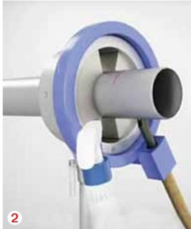
2 Positionner le tube dans le coupe tube. Graisser le tube avec le lubrifiant Blücher Réf. 007.100.050 avant de procéder à la coupe. Tournez la manivelle à 360° pour découper le tube.
