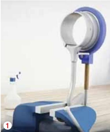
1 Installer le coupe tube manuel permettant de réaliser la coupe et un léger rétreint d'extrémité.
