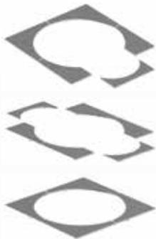
**Adaptateur pour carrelage** - cadres en acier installés pour l'adaptation avec un revêtement de sol en carrelage.
